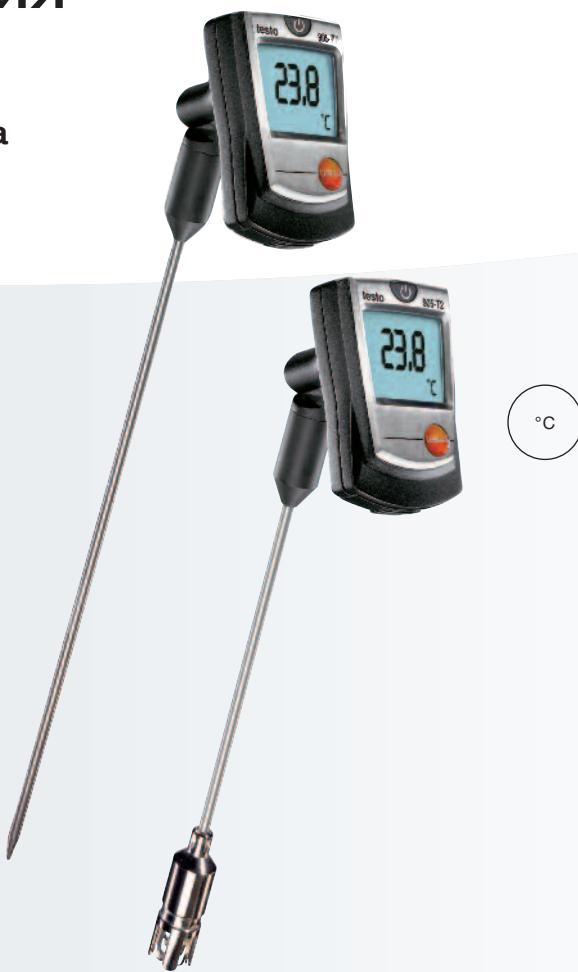
testo 905-T1 – быстродействующий проникающий термометр с широким измерительным диапазоном от -50 до +350 °C, краткосрочно до +500 °C (1-2 минуты). Прибор имеет профессиональный промышленный сенсор (термопара Тип K). Кроме того, термометр обладает высокой точностью измерений, в частности в верхней части измерительного диапазона.
